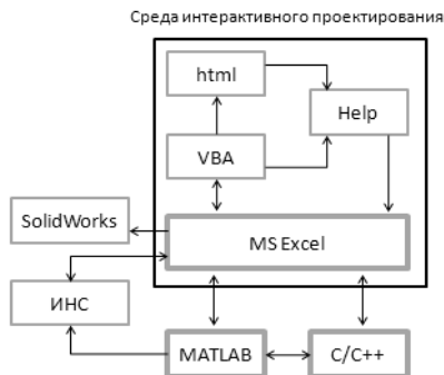
Рис. 3. Структура приложений и схема их взаимодействия
