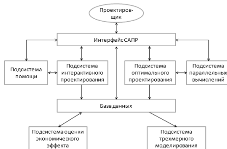
Рис. 2. Структура САПР трансформаторов Электромеханика и магнитожиidкостные устройства
